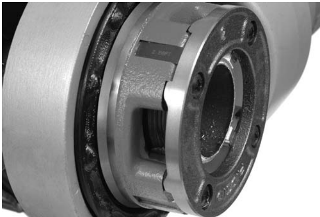
Figure 15 – Tuyau arrivé à fleur des filières
