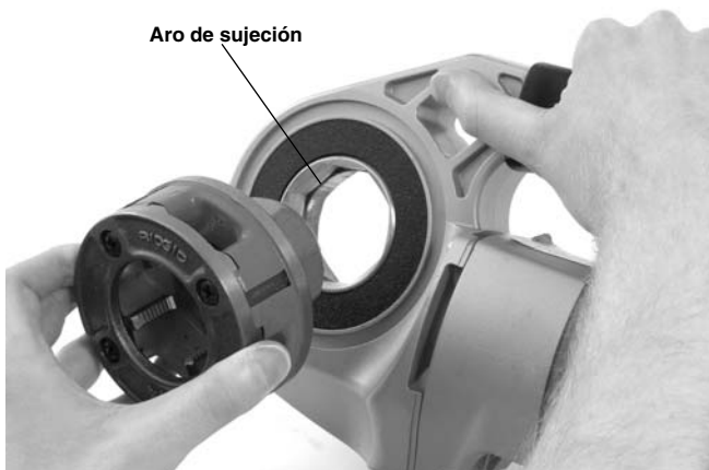
Figura 9 – Montaje de un cabezal roscador en un accionamiento motorizado 600-I
