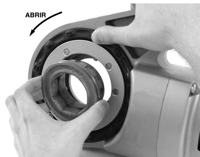
Figura 8 – Montaje del adaptador en la máquina 690-I
