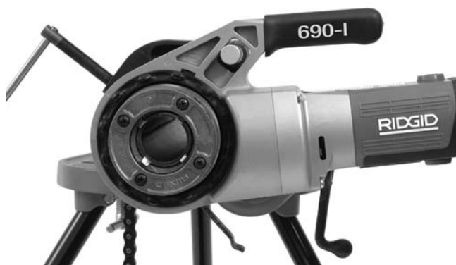
Figure 12 – Orientation appropriée du système d'entraînement
