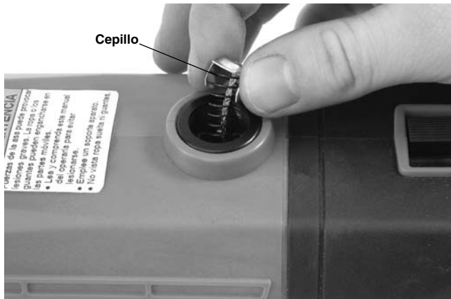
Figura 18 – Colocación del cepillo
