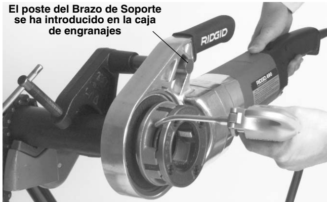
Figura 7 – Aplicación de aceite mientras se rosca
