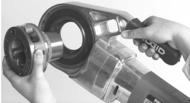
Figure 3 – Instalación de un cabezal de terrajas No. 11-R
