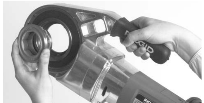
Figure 2 – Installation de l'adaptateur de têtes de filière type 11-R
