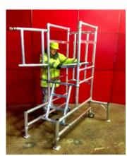
9) TO WORK AT UPPER LEVEL RELOCATE PLAT-FORM
